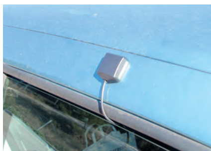
Figura 3. Antena del receptor GPS ubicada en la parte superior del vehículo
