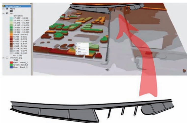
Figura 13: Esquema de modelo digital de la obra y superposición al modelo digital de elevaciones del terreno en los métodos numéricos 2D.
