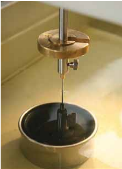
Ensayo de Penetración.
