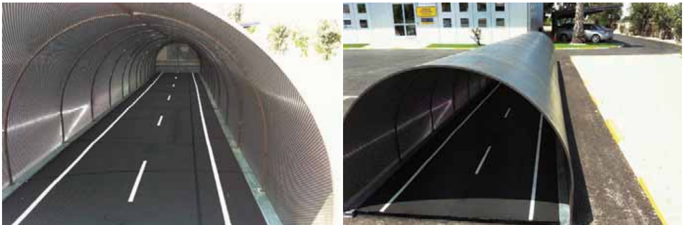
Figura 13: Imágenes de la construcción de la maqueta de transición lúminica a escala 1/6. Ubicada en el Centro de Conservación y Explotación del sector de carreteras de Murcia 4.
