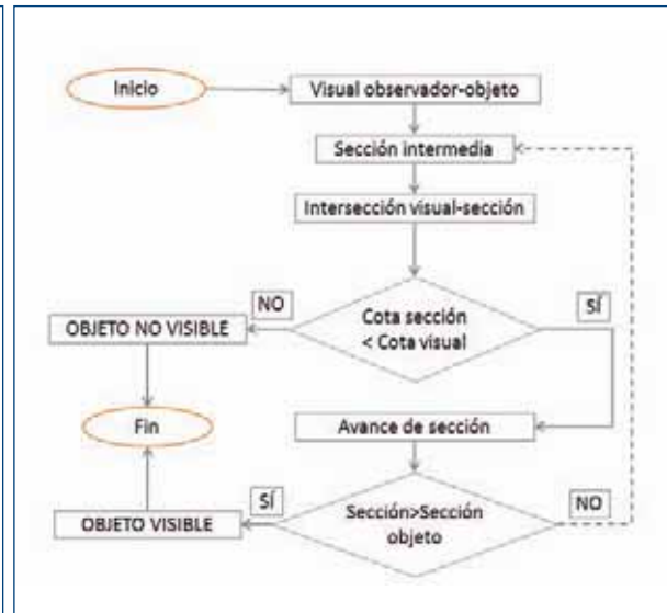
Figura 4: Diagrama de flujo para la comprobación de visibilidad.
