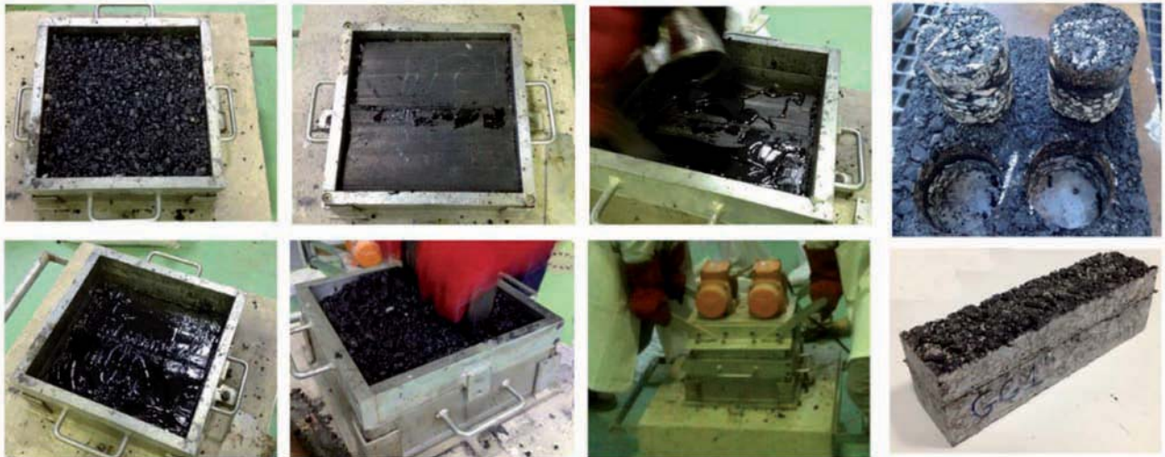
Figura 7. Fabricación de las probetas empleadas en el estudio de laboratorio llevado a cabo.
