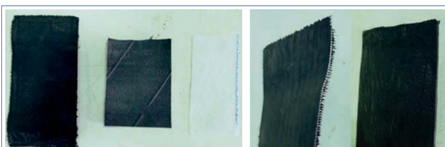
Figura 4. Detalle de las tres capas evaluadas (metálica, fibras y geotextil), así como de la presencia de caucho recubriendo la capa metálica y la textil.
