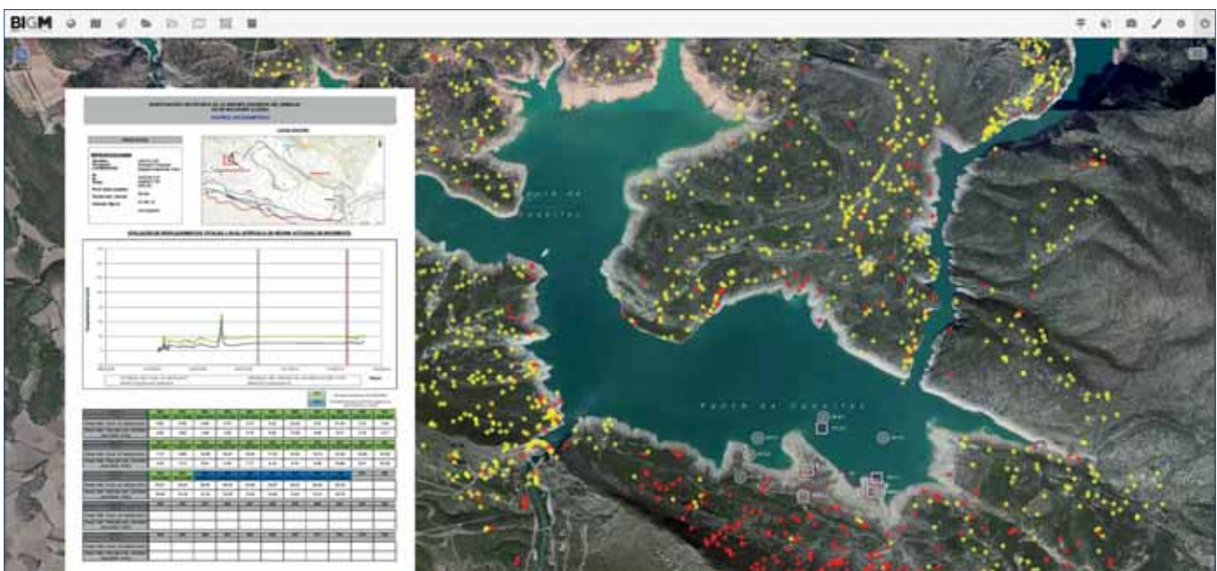
Información obtenida de seguimiento con satélite TERRASAR-X con deslizamiento de laderas. Informe de piezómetros instalados en la presa
