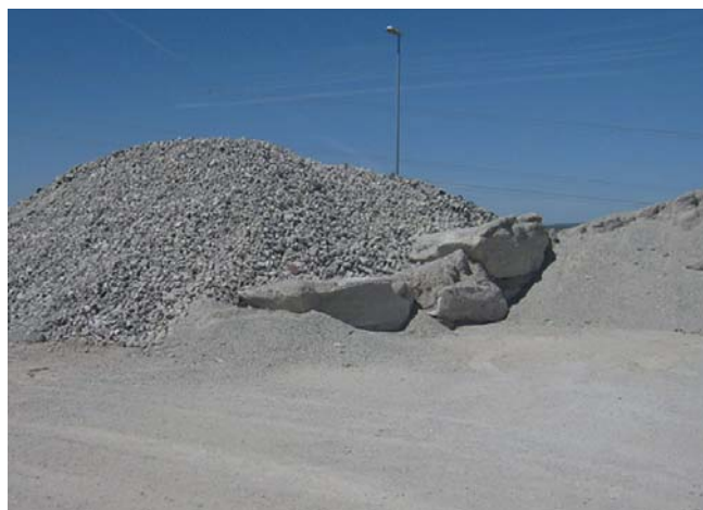
Foto 1. Acopio de árido reciclado. Su distribución granulométrica posterior dependerá del uso al que haya de estar destinado, o su uso posterior condicionará dicha distribución
