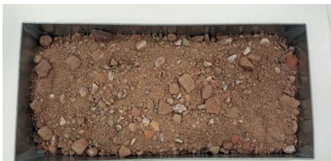
Foto 2. Árido mixto procedente de residuos de construcción y demolición
