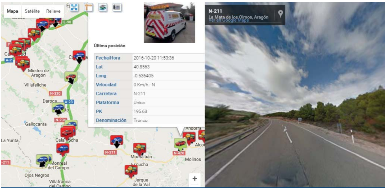
Figura 10. Localización de la flota de vehículos en un momento determinado. La plataforma debe utilizar un protocolo único para todos los Sectores de Conservación, que permita visualizar la localización de todos los vehículos conjuntamente, independientemente del Sector al que pertenezcan, del tipo de GPS que lleve el vehículo y de la empresa que lo haya instalado
