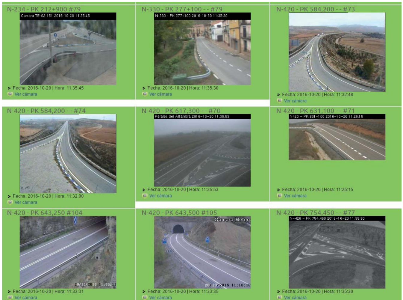
Figura 7. Ejemplo de visualización conjunta en tiempo real de una serie de cámaras de explotación, ubicadas en este caso en carreteras convencionales
