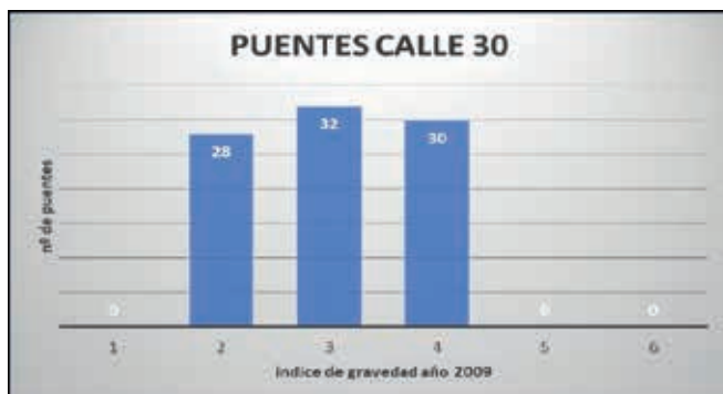
Figura 3. Distribución del nº de puentes M-30 en función de su estado. 2009
