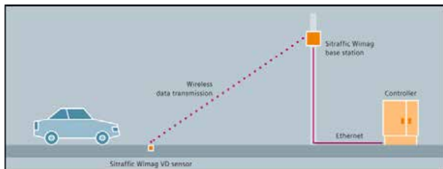
Figura 14. Esquema de funcionamiento de los sensores de tráfico inalámbricos. (Fuente: https://assets.new.siemens.com)
