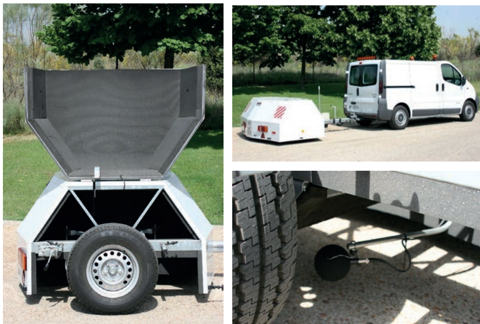
Figura 2. Equipo de medida CPX del CEDEX.
