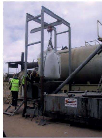
Figura 6. Planta móvil de fabricación de betún mejorado con caucho. Descarga de PNFVU
