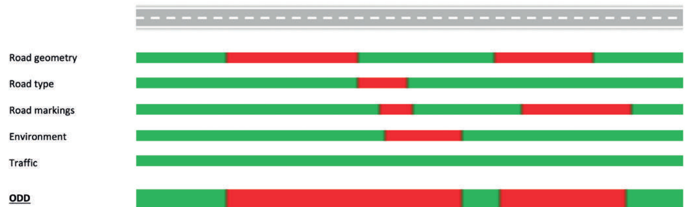
Figura 1. Zonas compatibles con el ODD del vehículo, en función de distintos factores limitantes.
