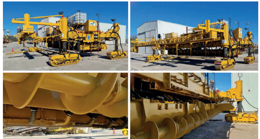
Figura 10. CMI SF-450 para el hormigón magro y la capa inferior del pavimento bicapa (Fuente: FCC)
