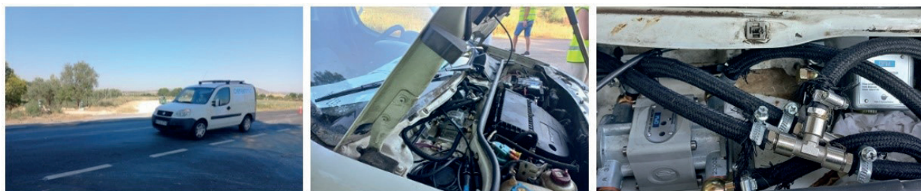
Figura 11. Vehículo de ensayo y detalle instalación de los dos caudalímetros
