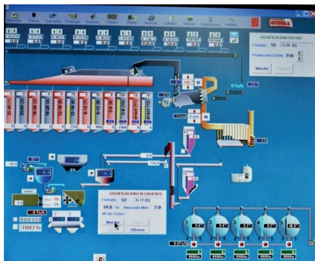
Figura 3. Esquema informático del panel de fabricación de plantas de finales del siglo XX
