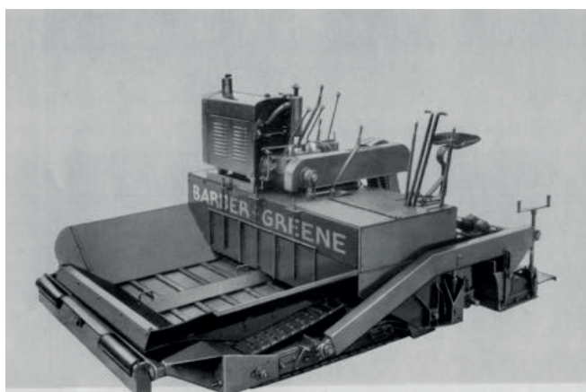
Figura 14: Extendedora Modelo 879 de Barber-Greene (1936) 8
