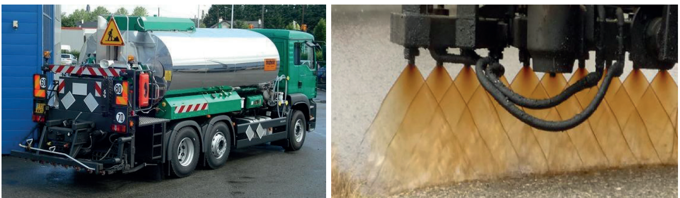
Figura 11. A la izquierda, cisterna de riego. A la derecha, detalle de los abanicos
