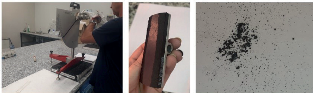
Figura 5. Péndulo de fricción. Detalle de las pastillas de caucho utilizadas y su desgaste mediante el ensayo.
