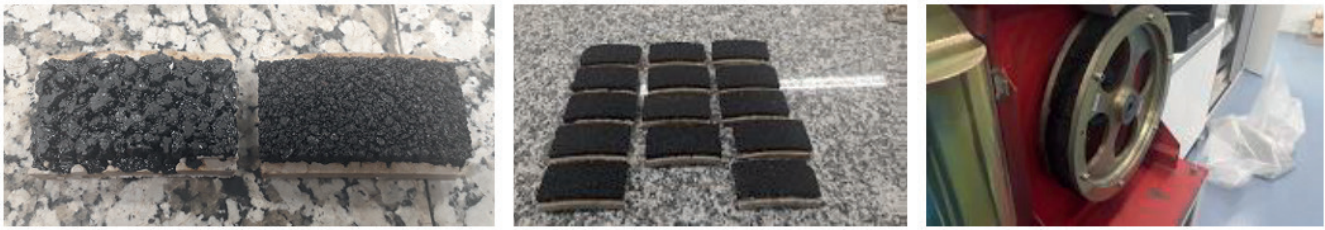
Figura 2. Detalle del proceso de fabricación de las probetas para rueda de CPA.
