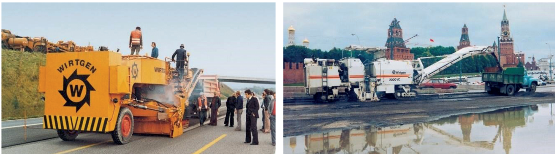
Figura 13: Fresadoras en frío. Carga trasera (izda) y delantera (dcha)
