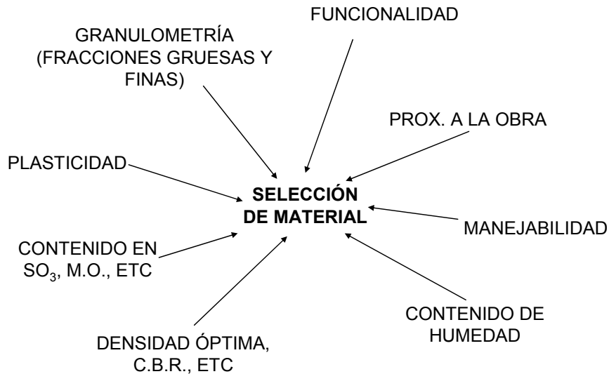
Fig. 6. Selección del material de un terraplén (OTEO, 1994)
