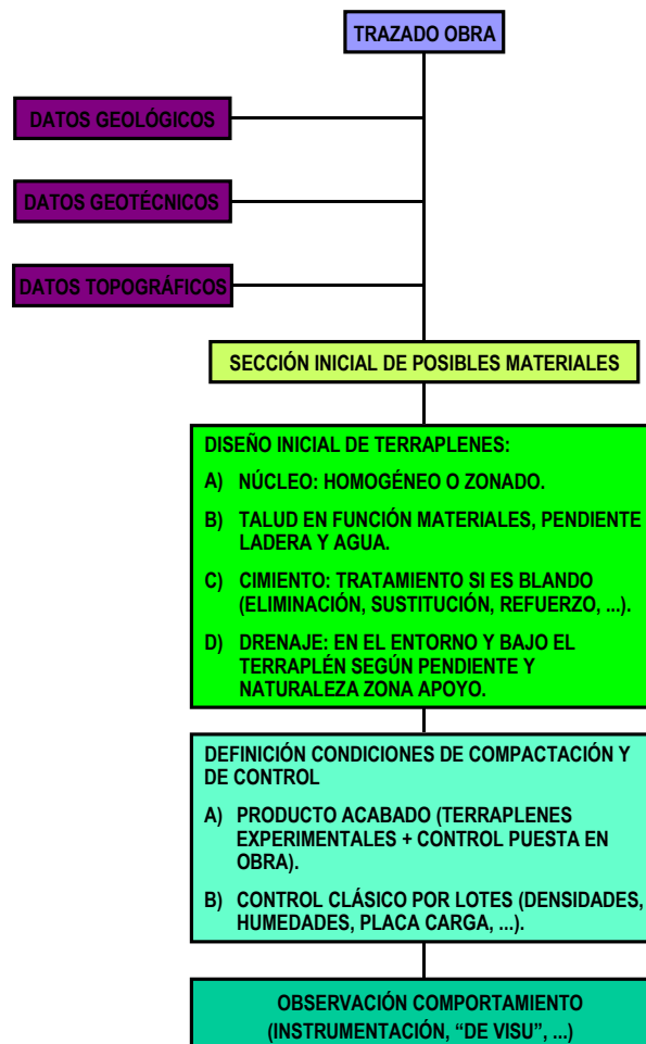
Fig. 4. Diseño y ejecución de terraplenes
