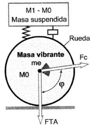
Figura 7. Esquema de funcionamiento de la rueda vibratoria
