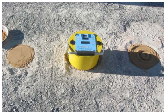
Foto 4.- Realización del ensayo con el geogauge
