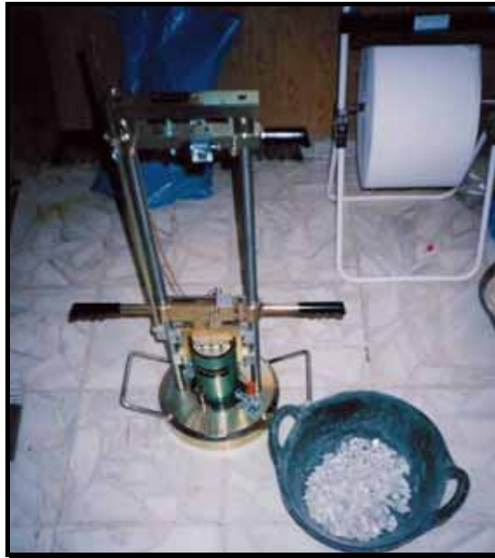
Foto 2.1.- Detalle del equipo MCV con el que se obtiene el índice “CCV”
