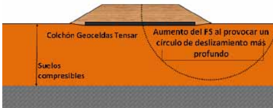
Fig 5: Aumento del factor de seguridad
