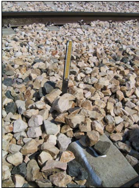
Figura 12. Detalle de una regleta de nivelación
