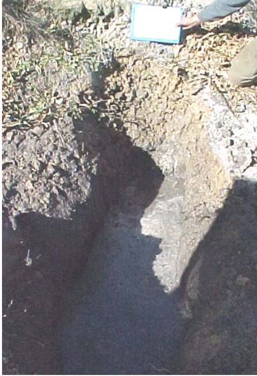
Figura 2.3: Ejemplo de calicatas mecánicas excavadas.
