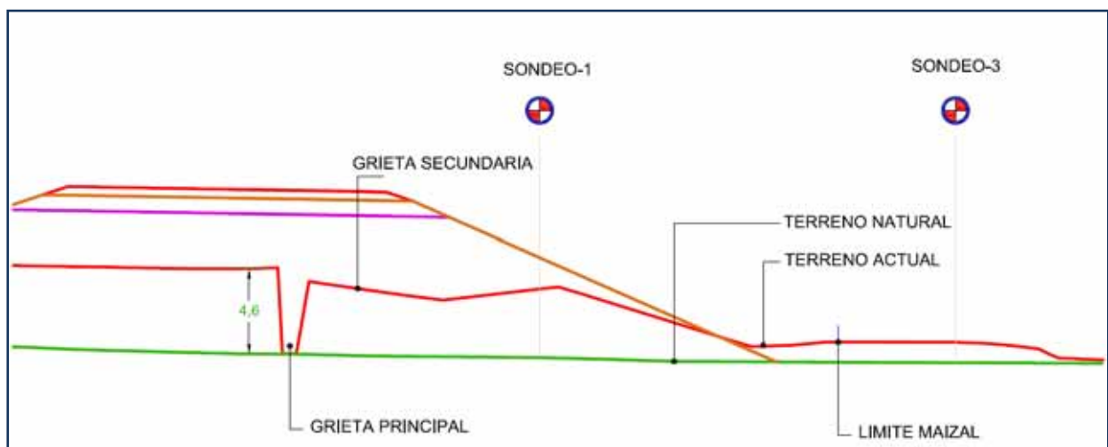
Figura 2.- Perfil transversal representativo de la sección final y de la del momento de la rotura.
