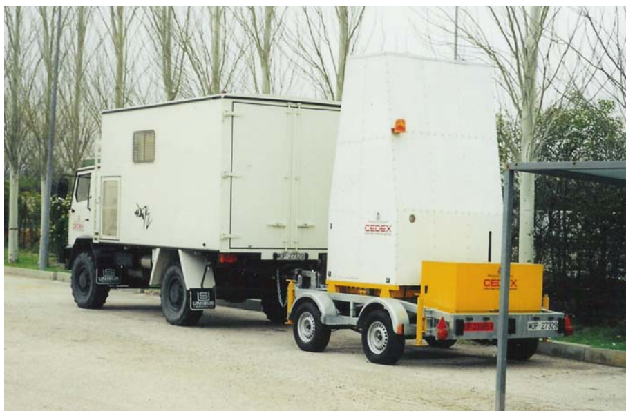
Foto 2.- Vehículo y remolque con el dispositivo de impacto para realizar el ensayo AEOS
