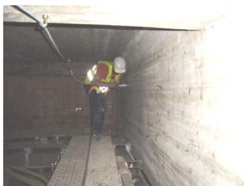
La extracción de probetas testigo permite además de realizar los ensayos mecánicos y fisicoquímicos para estudiar las condiciones de seguridad y durabilidad de los hormigones, determinar por la inspección visual de las probetas las distintas capas de materiales que constituyen el tablero, observar la macroporosidad del hormigón, etc.
