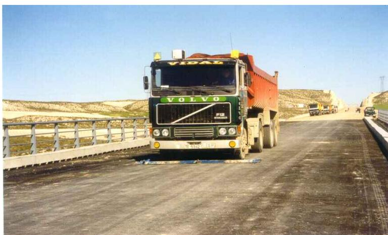
Paso de un camión sobre el tablón RILEM
