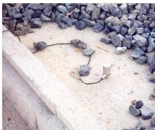
Si se desean obtener coeficientes de impacto es recomendable medir flechas o velocidades. Esto puede realizarse bien mediante el uso de transductores que refieren el tablero del puente al terreno a través de cables bien mediante el uso de transductores Láser que mediante interferometría obtienen los valores buscados. En las fotografías siguientes se pueden observar equipos como los citados:
