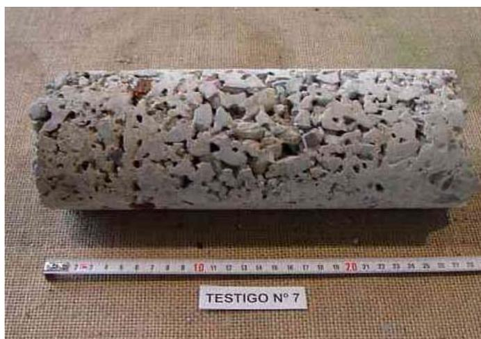
Normalmente los ensayos encaminados a determinar la durabilidad de los hormigones precisan de la extracción de probetas testigo. Es básico entonces escoger las zonas de extracción en función de la exposición de los elementos, ya que de lo contrario se obtendrán resultados anómalos.
