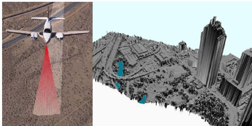
Figura nº 10. LiDAR aerotransportado y datos capturados
