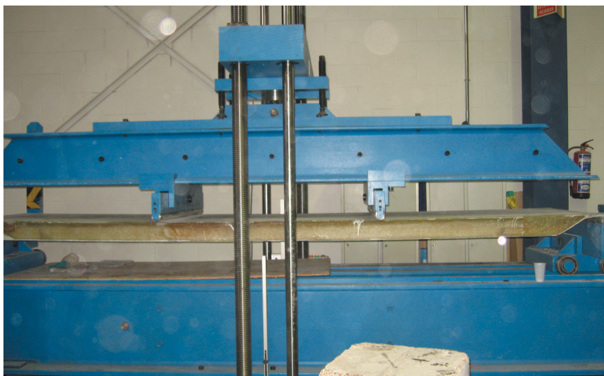
Ensayo de carga de una de las prelosas llevada a rotura.
