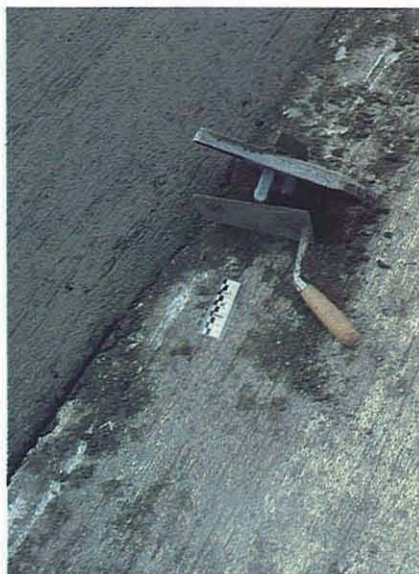
Foto 12 Llana especial para la realización de juntas en fresco
