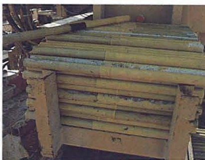
Foto 10 Pasadores con envoltura plástica cubriendo la totalidad de su superficie
