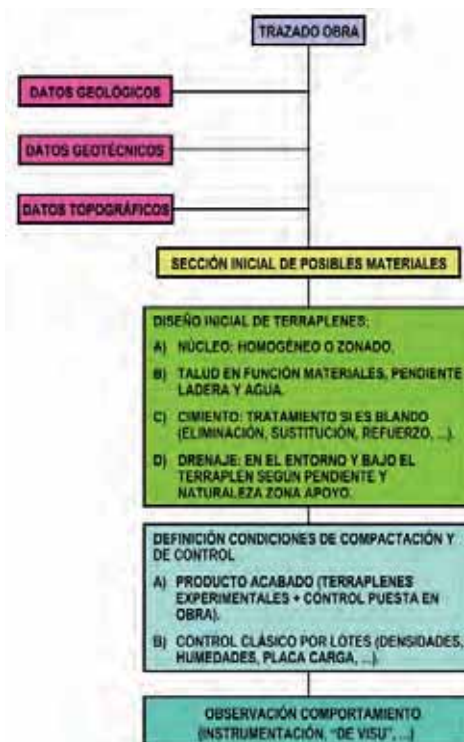
Figura 4. Diseño y ejecución de terraplenes
