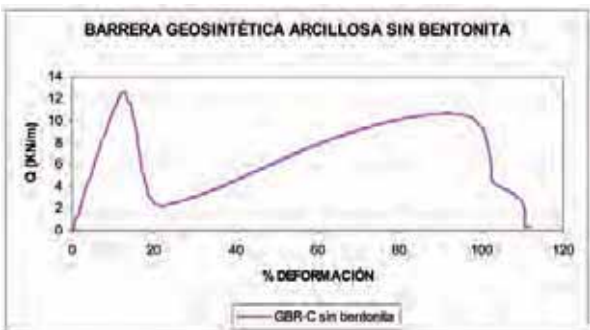
Figura 9. Curva tensión-deformación del GBR-C sin bentonita (sentido transversal)
