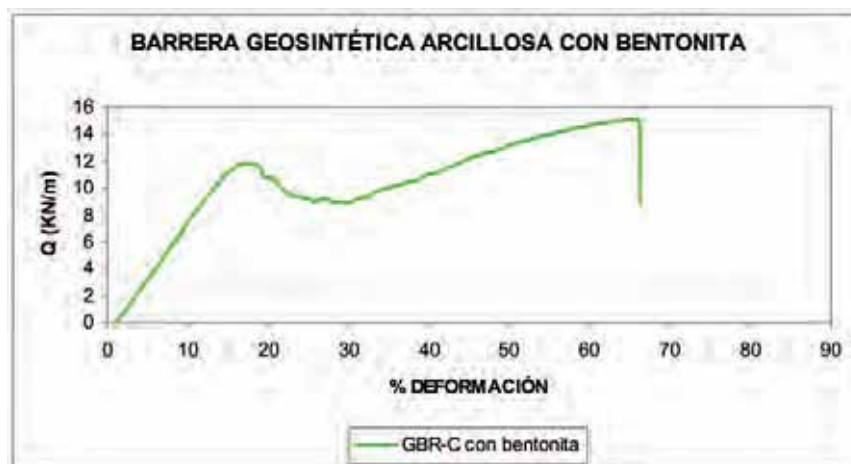
Figura 17. Curva tensión-deformación correspondiente al GBR-C con bentonita (sentido longitudinal)
