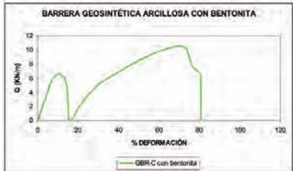
Figura 10. Curva tensión-deformación del GBR-C con bentonita (sentido transversal)
