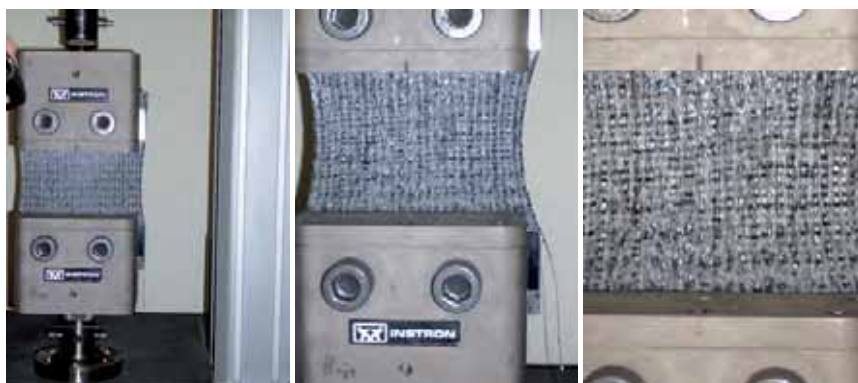
Figura 12. Aspecto del GBR-C por el lado del geotextil no tejido, una vez superado el primer pico y antes de que se produzca su rotura (segundo pico)
