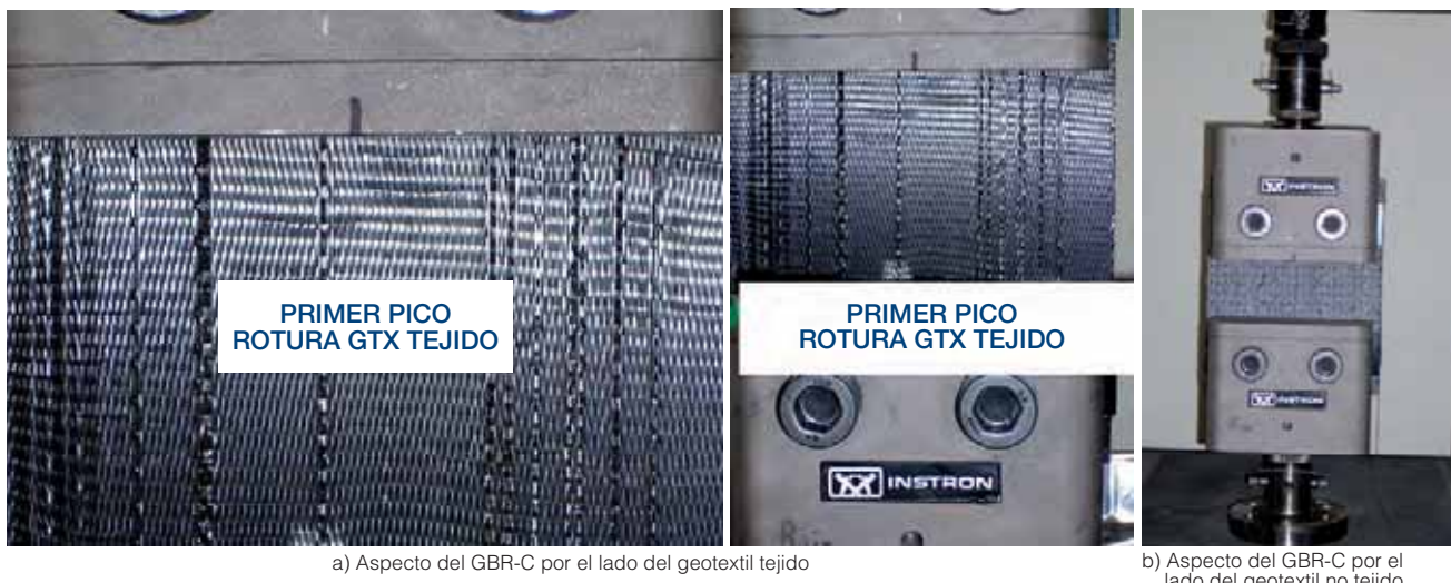
Figura 11. Aspecto del GBR-C una vez alcanzado el valor de carga y deformación correspondiente al primer pico: a) por el lado del geotextil tejido, b) por el lado del geotextil no tejido
