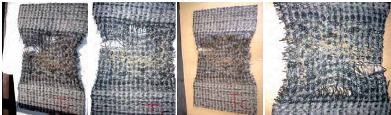
Figura 14. Estado de las probetas de GBR-C, una vez rotas. Se aprecia el deterioro completo de los geotextiles, tejidos y no tejidos, así como la salida al exterior de la bentonita
