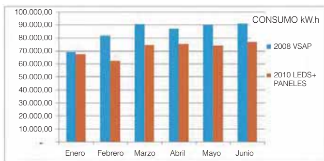
Figura 9. Consumo con Vapor de Sodio de alta presión ( high pressure sodium ) vs Leds
