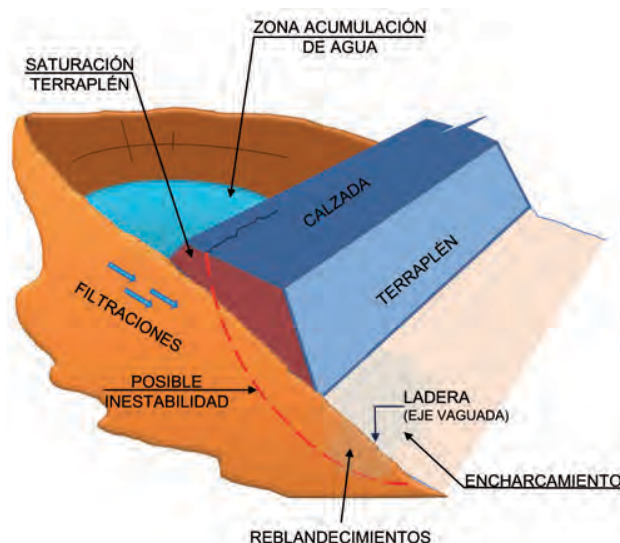
Figura 48. Efecto del agua en terraplén a media ladera, sobre vaguada
