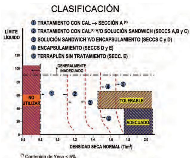
Figura 29. Posible criterio de clasificación de materiales arcillosos para su utilización en terraplenes (Oteo, 2007)
