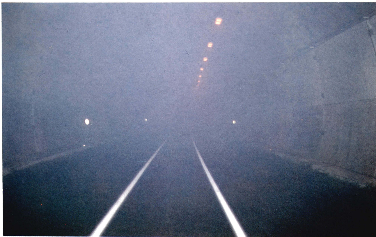
Foto 3: Fase inicial del ensayo. El humo comienza a ocupar el túnel
