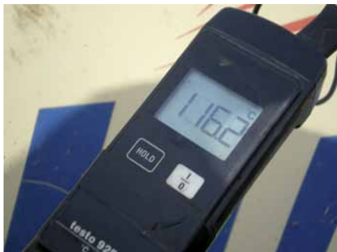
Fotos 5 y 6. Medición de la temperatura de la mezcla a la llegada a obra y de stress térmico en la extendedora
