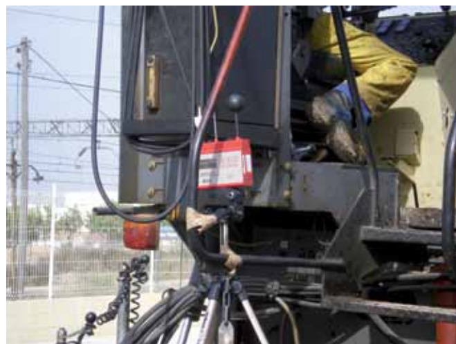
Fotos 5 y 6. Medición de la temperatura de la mezcla a la llegada a obra y de stress térmico en la extendedora
