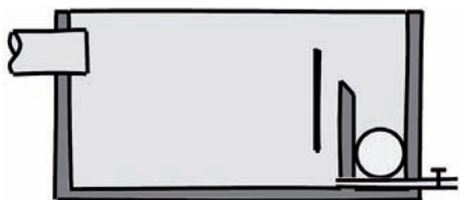
Figura 6 : Esquema de cámara (o balsa) de retención de hormigón, con pantalla deflitora para separación de grasas.
