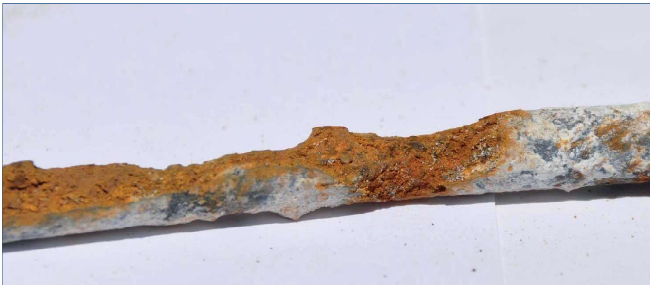
Figura 33. Estribo de armadura pasiva con picaduras de corrosión (ubicación desconocida)
