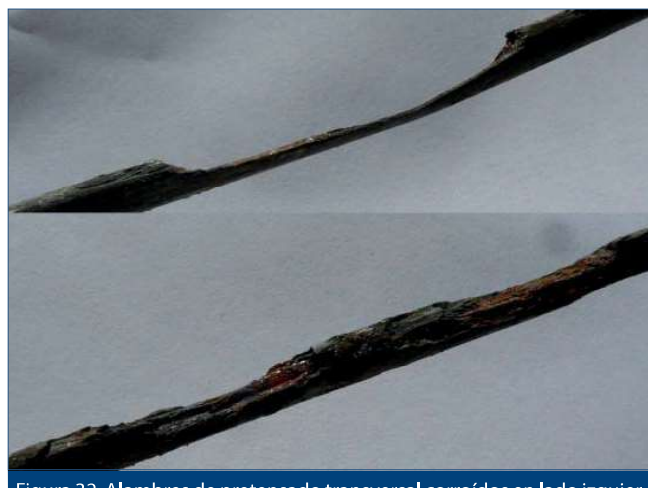
Figura 32. Alambres de pretensado transversal corroídos en lado izquierdo, en losa sobre viga 2
