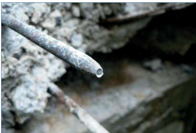
Figura 20. Vista de alambre roto el día 29 de mayo. La pérdida de sección obligó a los no rotos por corrosión a movilizar toda su capacidad
