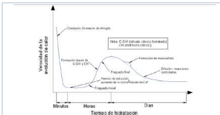
Figura 6. Representación esquemática de la hidratación del cemento
