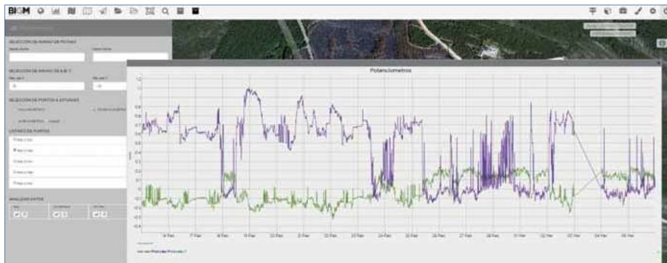
Gráficos de explotación de un aerogenerador comparando velocidad del viento e inclinación de la torre
