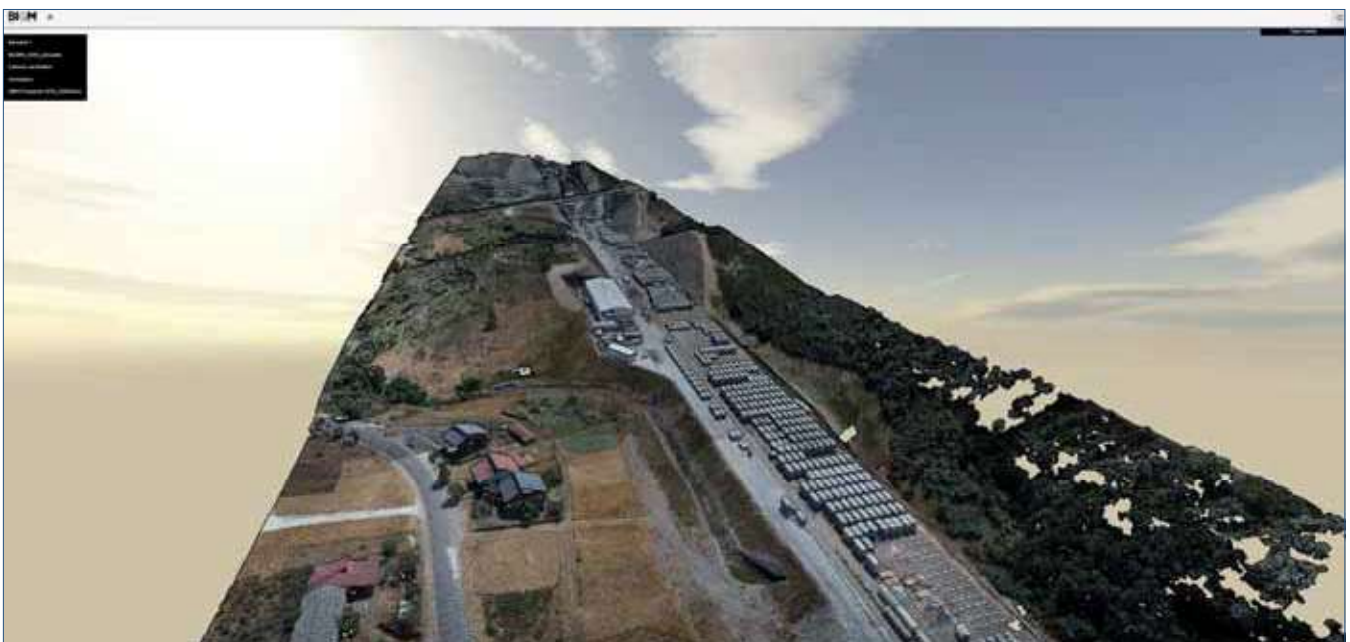
Visualización del modelo 3D generado a partir de la nube de puntos mediante un dron
