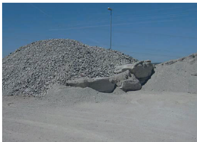
Foto 1. Acopio de árido reciclado. Su distribución granulométrica posterior dependerá del uso al que haya de estar destinado, o su uso posterior condicionará dicha distribución
