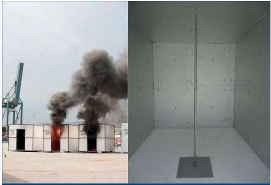
Figuras 2 y 3. Ensayo a escala real "Room Corner Test" con maquetas realizadas según ISO 9.705 y EN 14.390
