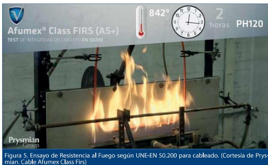
Figura 5. Ensayo de Resistencia al Fuego según UNE-EN 50.200 para cableado. (Cortesía de Prysmian. Cable Afumex Class Firs)
