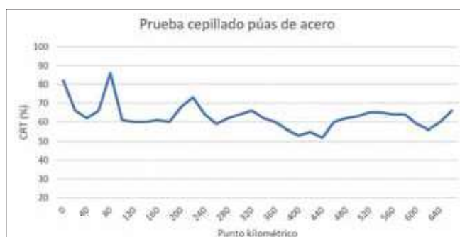
Figura 8. Valores de CRT obtenidos con equipo SCRIM tras cepillado con barredora de púas de acero
