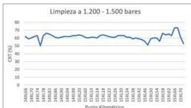
Figura 9. Valores de CRT obtenidos con equipo SCRIM tras limpieza profunda a 1200-1500 bares
