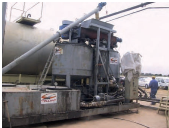
Figura 7. Planta móvil de fabricación de betún mejorado con caucho.
