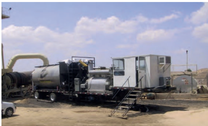
Figura 8. Planta móvil de fabricación de betún modificado de alta viscosidad con caucho.
