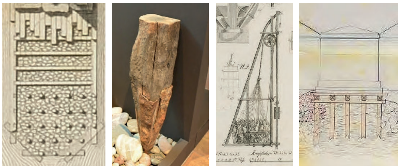
Figura 2. De izquierda a derecha, esquema típico de las cimentaciones con pilotes y encepado de madera (tomado de Wiebeking y Perronet, Biblioteca de la ETSICCP-UPM). Extremo inferior de pilote con azuche (Museum für Geschichte, Basilea, Suiza). Maquinaria para hincas de pilotes (tomado de Perronet y Wiebeking). Detalle de emparrillado, tarima y zampeado tomado del proyecto de refuerzo del puente de Deba de 1892
