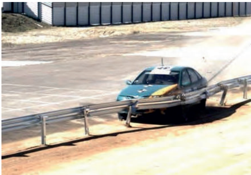
Ensayo de choque. Cidaut.
