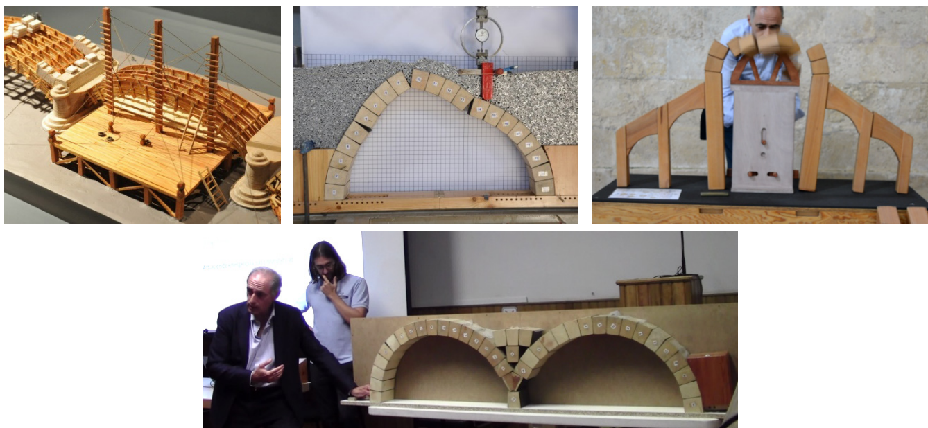
Figura 15. Modelos reducidos y físicos, válidos para entender el comportamiento de las construcciones de piedra (CEHOPU, equipo investigador, abadía de Arthous, y puente de Deba. Las tres últimas, fotos de los autores)
