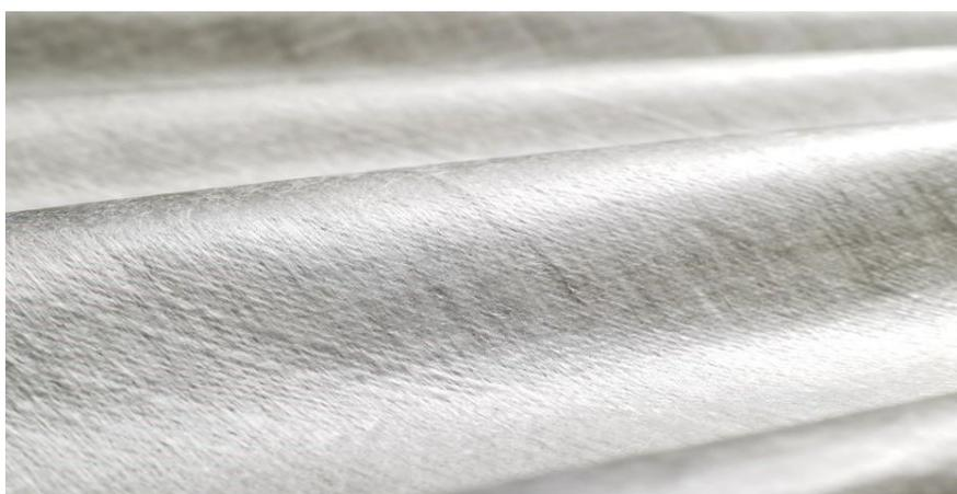
Figura 2. Geotextil no tejido (GTX-NW)
