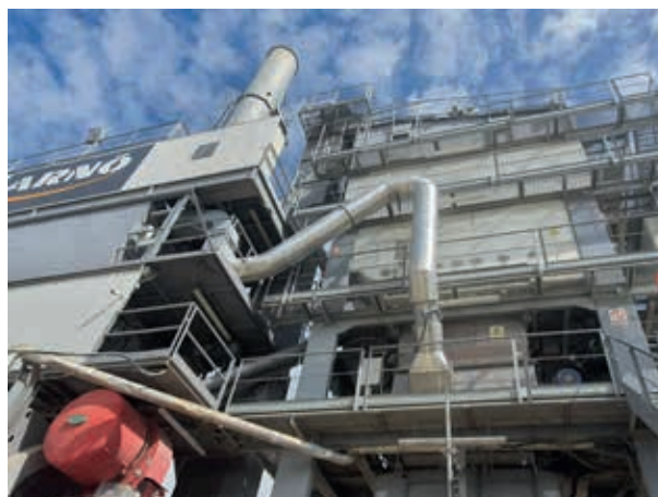
Fotografías 1 y 2. Tolvas para la introducción de áridos y RAP fríos (izquierda) y sistema de evacuación de vapor (derecha)
