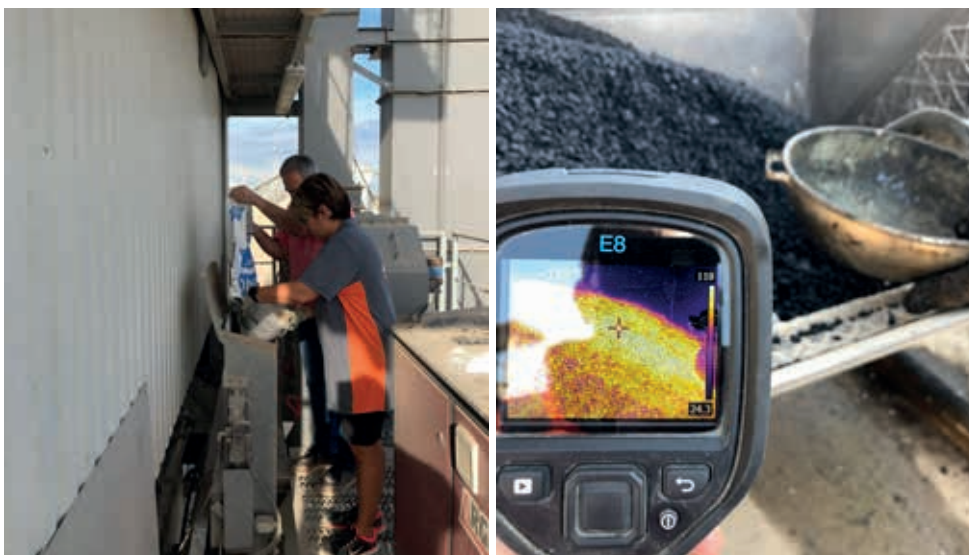
Fotografías 7 y 8. Introducción de hidróxido cálcico y aditivo seco en la mezcladora (izquierda) y control termográfico de la temperatura (derecha).
