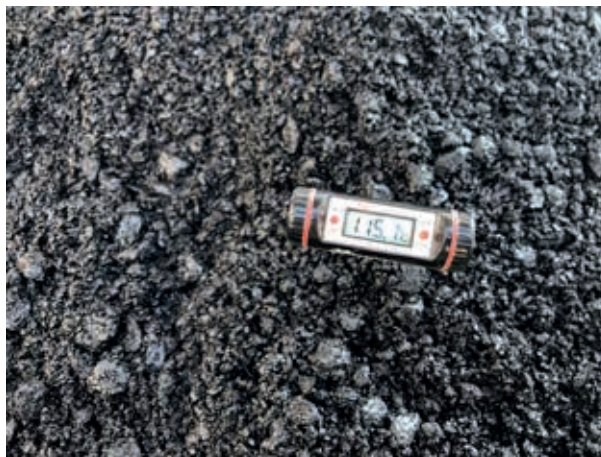
Fotografías 5 y 6. Controles de temperatura de la mezcla de áridos (izquierda) y de la mezcla bituminosa semicaliente (derecha).
