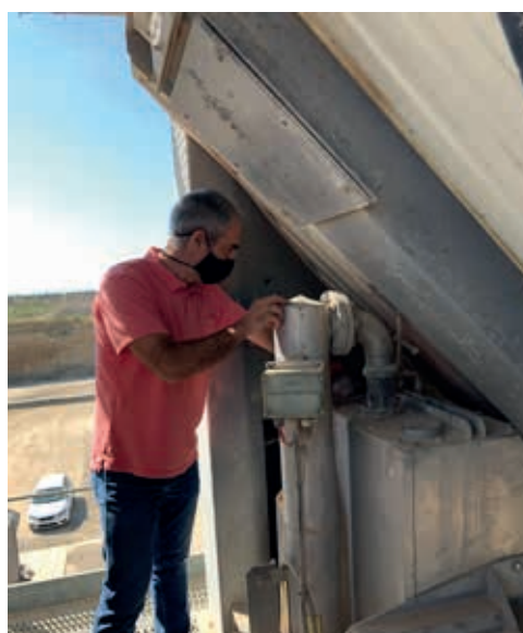
Fotografías 3 y 4. Introducción manual de aditivos sólidos en la mezcladora (izquierda) y líquidos en la báscula del betón (derecha)
