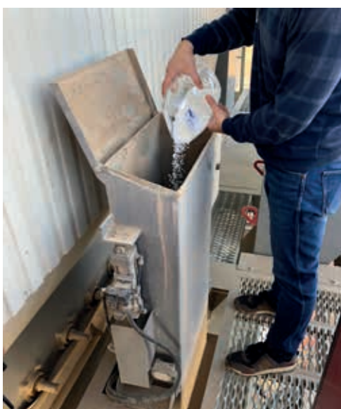
Fotografías 3 y 4. Introducción manual de aditivos sólidos en la mezcladora (izquierda) y líquidos en la báscula del betón (derecha)
