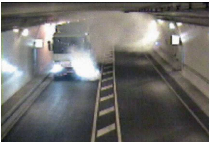
Ilustración 1. Avería del turbo de un camión
