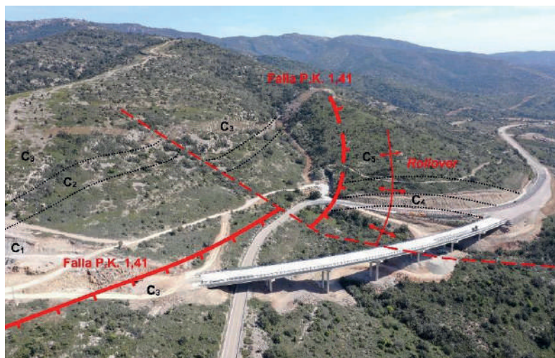
Figura 14. Panorámica de la Falla P.K. 1,41 situada al SE del Falso Túnel y del rollover existente al inicio del trazado (Mayo 2022)
