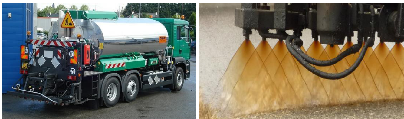
Figura 11. A la izquierda, cisterna de riego. A la derecha, detalle de los abanicos
