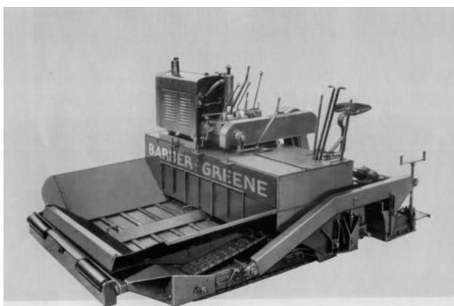
Figura 14: Extendedora Modelo 879 de Barber-Greene (1936) 8
