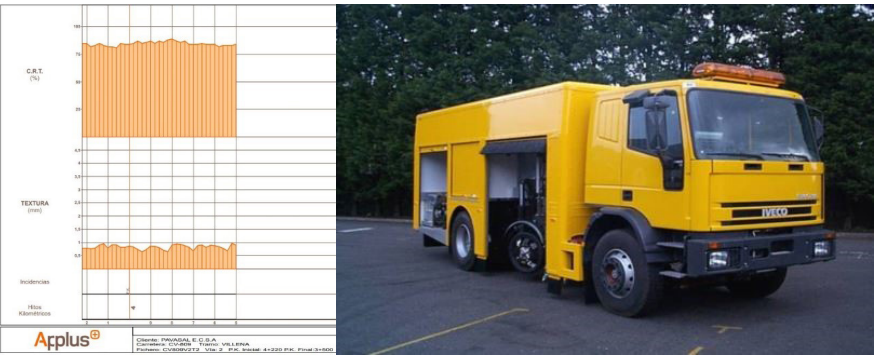
Figura 9. Izqda: Resultados CRT y textura de la mezcla AUTL. Dcha. Vehículo utilizado en el ensayo SCRIM.
