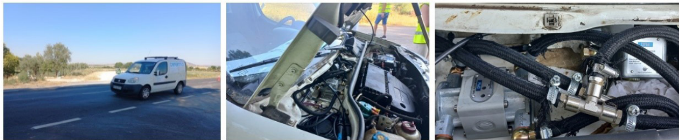
Figura 11. Vehículo de ensayo y detalle instalación de los dos caudalímetros
