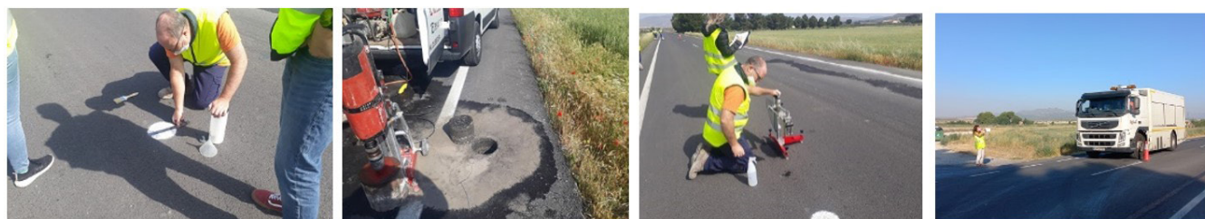
Figura 7. Ensayos de resistencia al deslizamiento y extracción de testigos para W&S.
