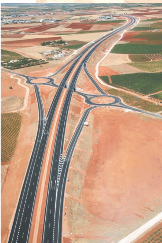
Foto superior izquierda: enlace de Ossa de Montiel, de tipo diamante con pesas. Foto derecha: enlace Villarrobledo Este, de tipo trompeta.
