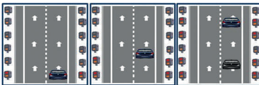
Figura 10. Esquema de funcionamientos de balizas detectoras en condiciones de baja visibilidad. Autovía A-8. Alto del Fiouco (Lugo). España
